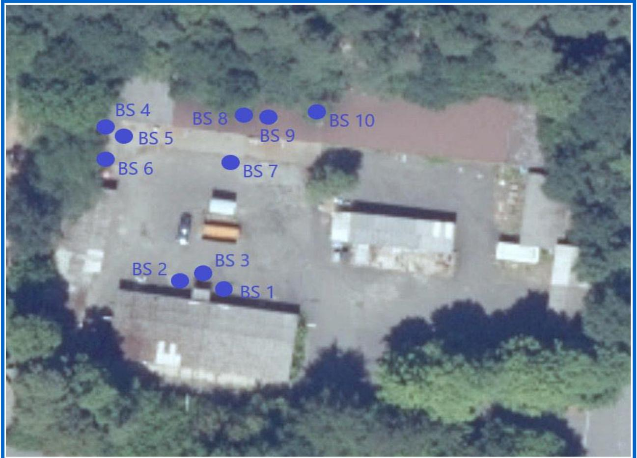
Abbildung 3: Lage der Bohrlochsondierungen orientierende Untersuchung im Bereich des Baubetriebshofs der Stadt Stadtallendorf in der Niederrheinischen Straße (Quelle der Kartengrundlage: [U13] (Ausschnitt, Daten unverändert))
